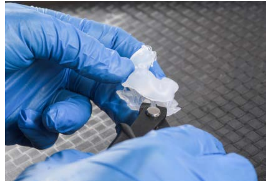
Fig. 16: Enlèvement des supports à l'aide des pinces
