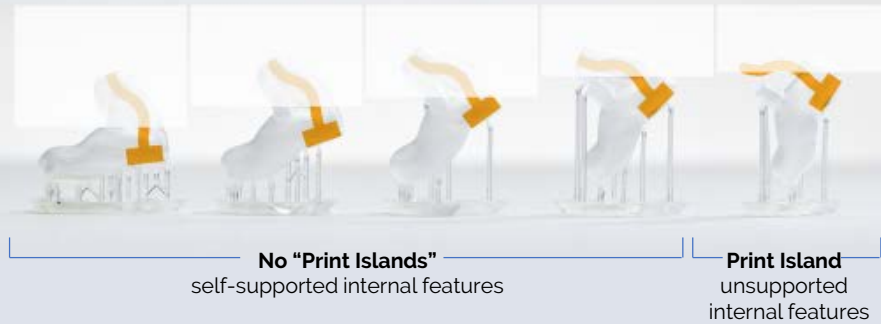
Fig. 10: Chacune de ces cinq impressions est identique, mais l'orientation peut déterminer le succès de l'impression. Les quatre impressions de gauche imprimeront sans problème, mais la cinquième impression est orientée de manière à ce que la fonction interne crée un îlot d'impression.
