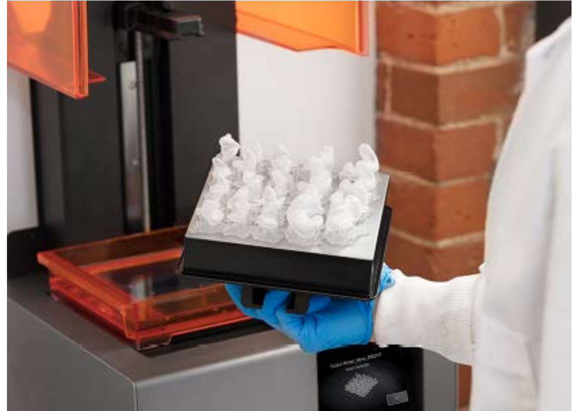
Fig. 12: Cette plate-forme complète de coquilles de moules auriculaires imprimées en 5 heures à 50 microns.
