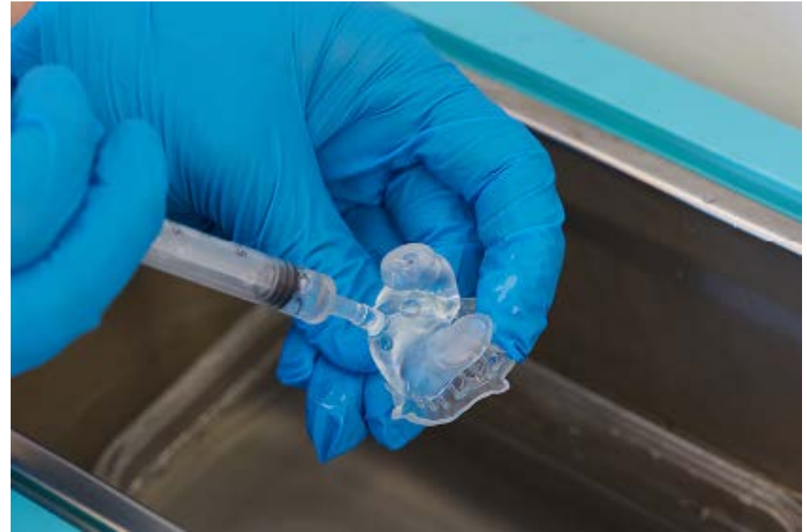
Fig. 13: Injecter l'IPA dans l'impression pour éliminer toute résine non polymérisée.
