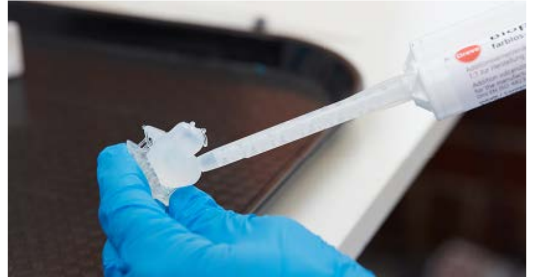
Fig. 15: Injection de la coque imprimée avec du silicone BioPor® AB 40 Shore de Dreve.
